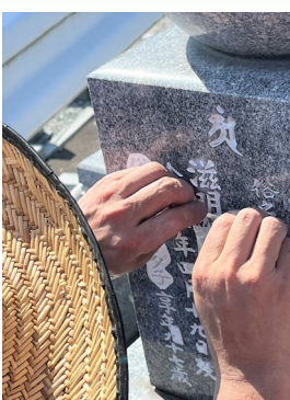
上の写真は追加字彫りをしている時の様子です。左から右へと作業が進む様子を追ってご覧ください。 字彫課の畠山さんが、中川さんの応援を受けながら一緒に施工しました。それにしても…暑そうですね(;^_^:
